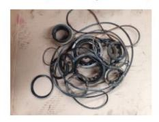
2.2- Assento do selo mecânico, inferior e superior com desgastes, colo do rolamento danificado;
