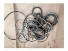
2.2- Assento do selo mecânico, inferior e superior com desgastes, colo do rolamento danificado;
